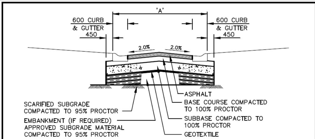
TYPICAL CURB & GUTTER ROAD CROSS SECTION
